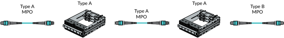
Méthode de polarité MPO R&M 40/100G Trunk A
