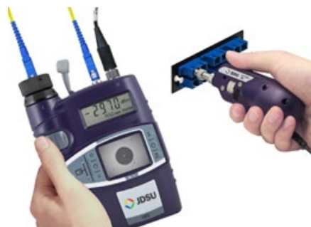
Outil d'inspection d'extrémité de fibre
