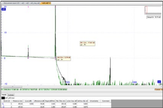
Vérification du connecteur de référence des cordons de test 1 et 2
